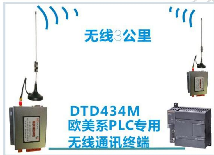
DTD434M 既可以实现点对点通信，也适合于点对多点，分散不便于挖沟布线等应用场合，不需要编写程序，不需要布线。DTD434M 不仅能与 PLC、DCS、智能仪表及传感器等设备组成无线测控网络，同时能与组态软件、人机界面、触摸屏、测控终端等工控产品实现无线 485 协议、西门子 PPI 协议、MODBUS 协议、欧美 PLC 通信协议等的组态，为工业测控领域提供了 3 公里范围内的低成本解决方案，大大节省了系统集成商现场调试和售后维修服务的费用。
